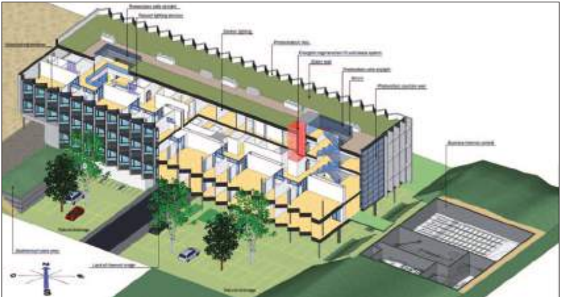
Fig. 2. Sección axonométrica. Pozos de luz, aparcamiento abierto y central de biomasa.
